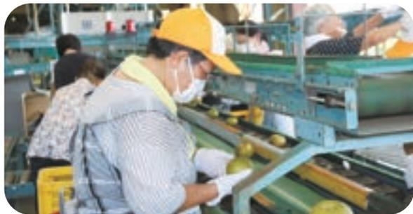
梨の傷や形のゆがみなどを人の目で確認し、規格内の梨は選果機に送られます。選果機に送られた梨はセンサーによって重量が計測され、その大きさに応じて選別されます。
