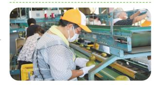
梨の傷や形のゆがみなどを人の目で確認し、規 格内の梨は選果機に送られます。選果機に送ら れた梨はセンサーによって重量が計測され、そ の大きさに応じて選別されます。
