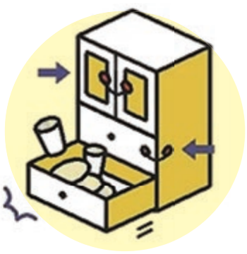
引き出しや開き扉には、飛び出し防止器具を付ける。
