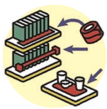
本棚などは、落下抑制テープや器具を取付け、滑り止めシートを敷く。
