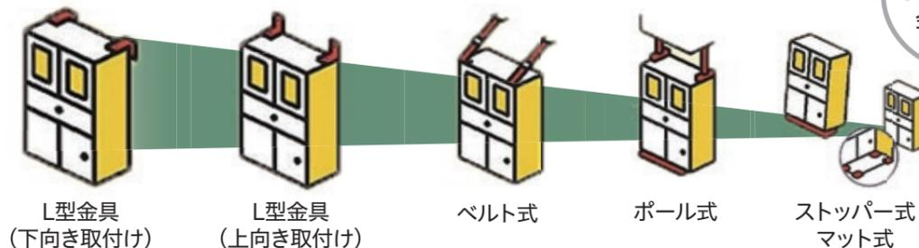
ポール式とマット式、ポール式とストッパー式のように組み合わせて使用するとL型金具(上向き取り付け)と同等の強度になるよ
