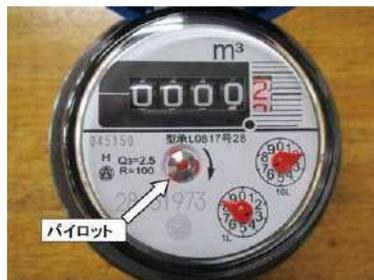
**内** 受水槽を設置している場合は例外ですが、蛇口を全て閉めた状態で水道メーターのパイロットと呼ばれる銀色の円盤が回っていたら漏水の可能性がります。
