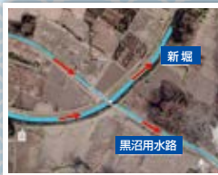
7 新堀・黒沼用水の立体交差
