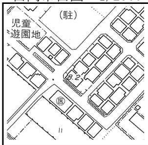
流出係数の決定に際しては、白岡市内の一部の区域（面積1.00ha）をモデル図として抜き出し、道路、宅地、間地、公園に分けて面積を測定し、それぞれの工種の流出係数掛け、荷重平均により流出係数を求める
