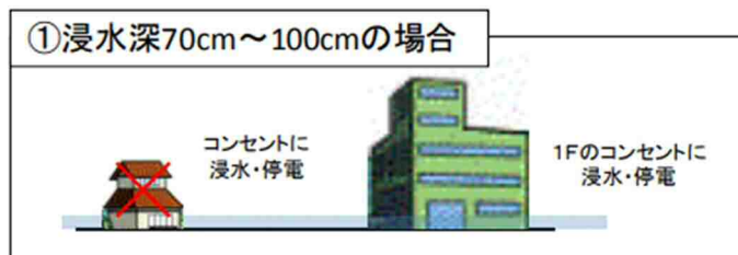
図 7-2 浸水による停電の考え方
